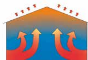
Calefacción por aire caliente
